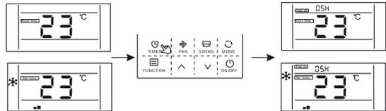
2. Кнопками ▲ и ▼ можно задать требуемое время таймера. Однократным нажатием интервал задается с шагом 0,5 ч до 24 часов. Если кнопка не будет нажата в течении 10 сек. пульт выйдет из меню настроек таймера. После 10 часов шаг установки составит 1 ч.
